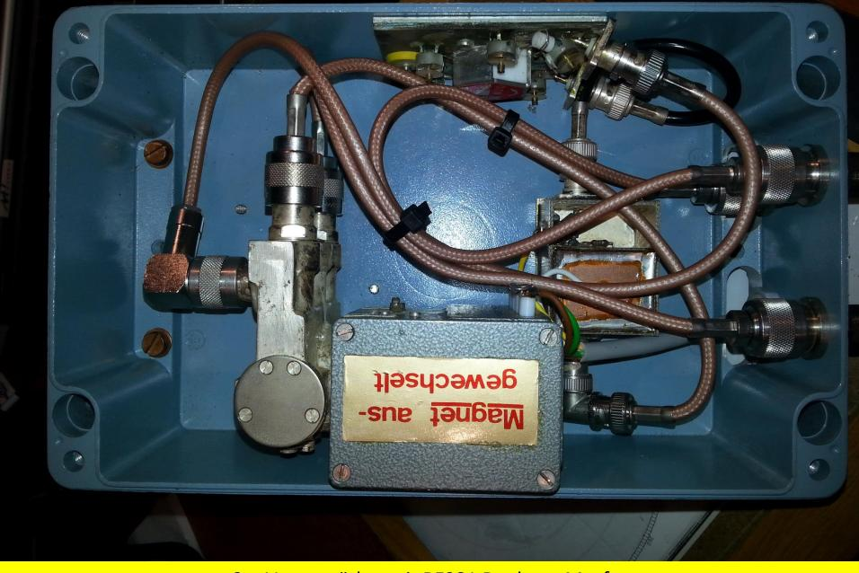
2m Vorverstärker mit BF981 Dualgate Mosfet Nf 0.7dB Gp 24dB (inklusive Dämpfung des Isolators) Dämpfung Anschluss ANT zu Anschluss TX 0.12dB. 6.8.2016 HB9MFL
