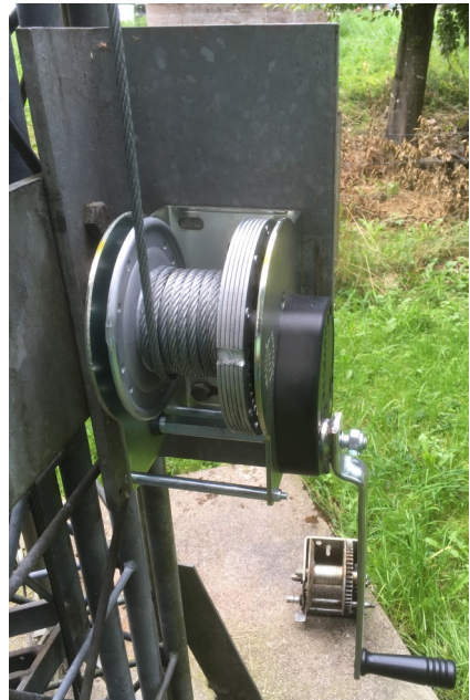
Oben: Neue, selbsthemmende Seilwinde mit neuem Drahtseil
